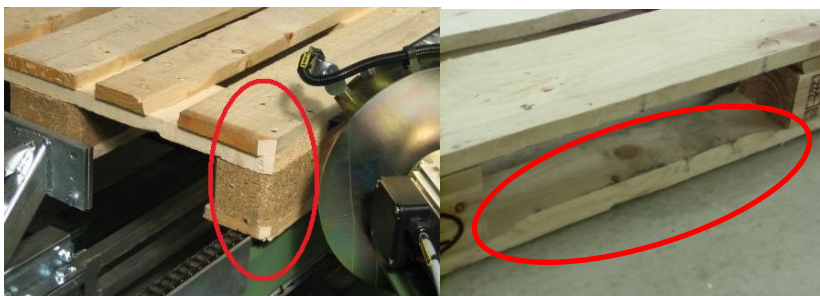
Abbildung 4: 4 Ecken gekappt und 3 Bodenbretter gefast
